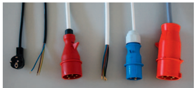
Flexible Kunststoffleitung mit Stecker betriebsfertig angeschlossen
